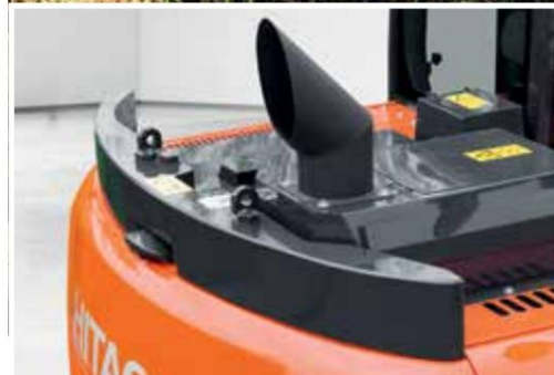
Malé přídavné protizávaží se snadno ovládá a zvyšuje stabilitu.
