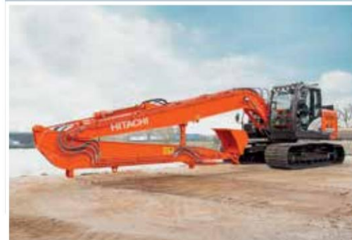
Konstrukce předního příslušenství umožňuje snadnou přepravu.
