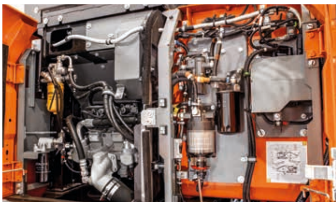
Filtry byly přemístěny pro snadný přístup.
