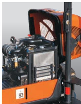
Kryty se širokými otvory umožňují snadno provádět údržbu stroje.
