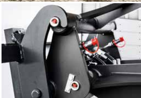
Elektrohydraulicky ovládaná rychlospojka pro rychlé upevnění příslušenství.
