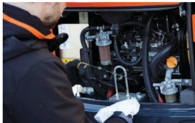
Místa každodenních kontrol jsou pro zvýšené pohodlí seskupena.
