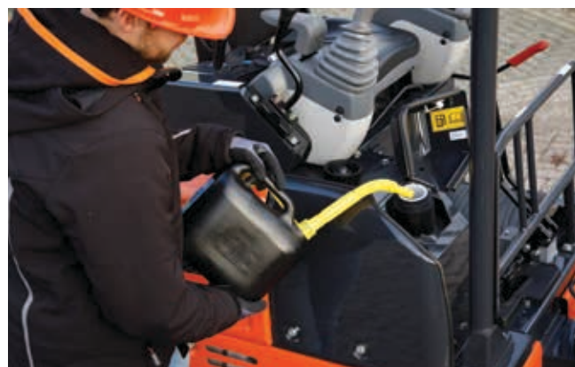
Dostatečný prostor okolo otvoru palivové nádrže usnadňuje doplňování paliva.
