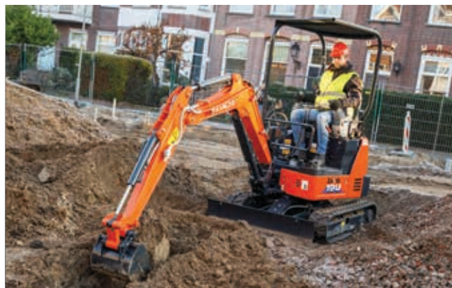
Vysouvací pásy zlepšují všestrannost a stabilitu.
