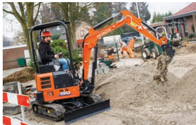
Krátký poloměr otáčení zadní části stroje je ideální pro práci ve stísněných prostorech.
