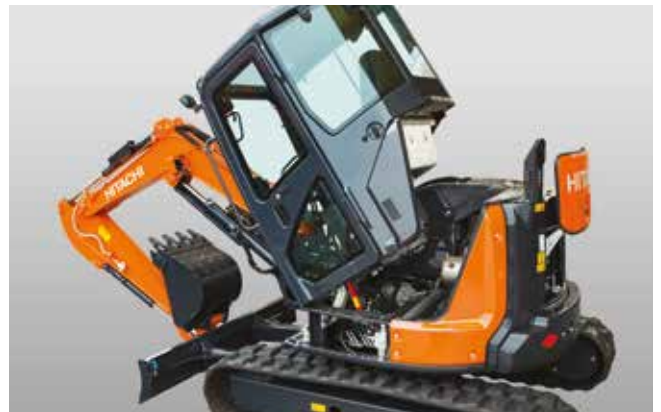
Naklápací podlaha usnadňuje přístup k motoru a řídicímu ventilu pro rychlou údržbu.
