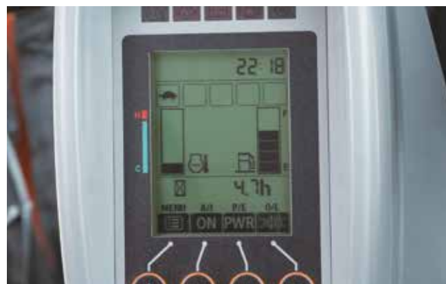
Multifunkční LCD monitor zobrazuje data přehledným způsobem.
