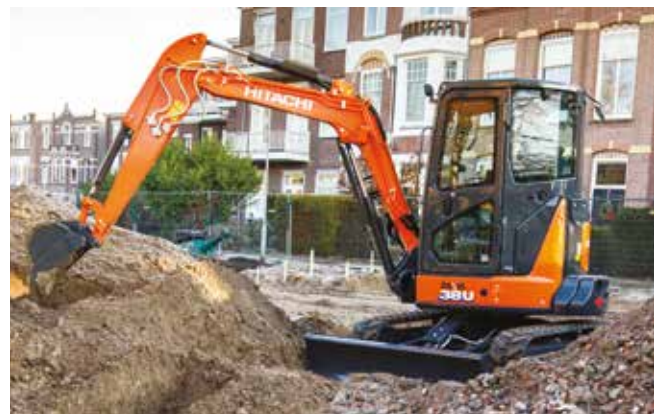
Krátký poloměr otáčení zadní části stroje ZX38U-6 je ideální pro práci ve stísněných prostorách.
